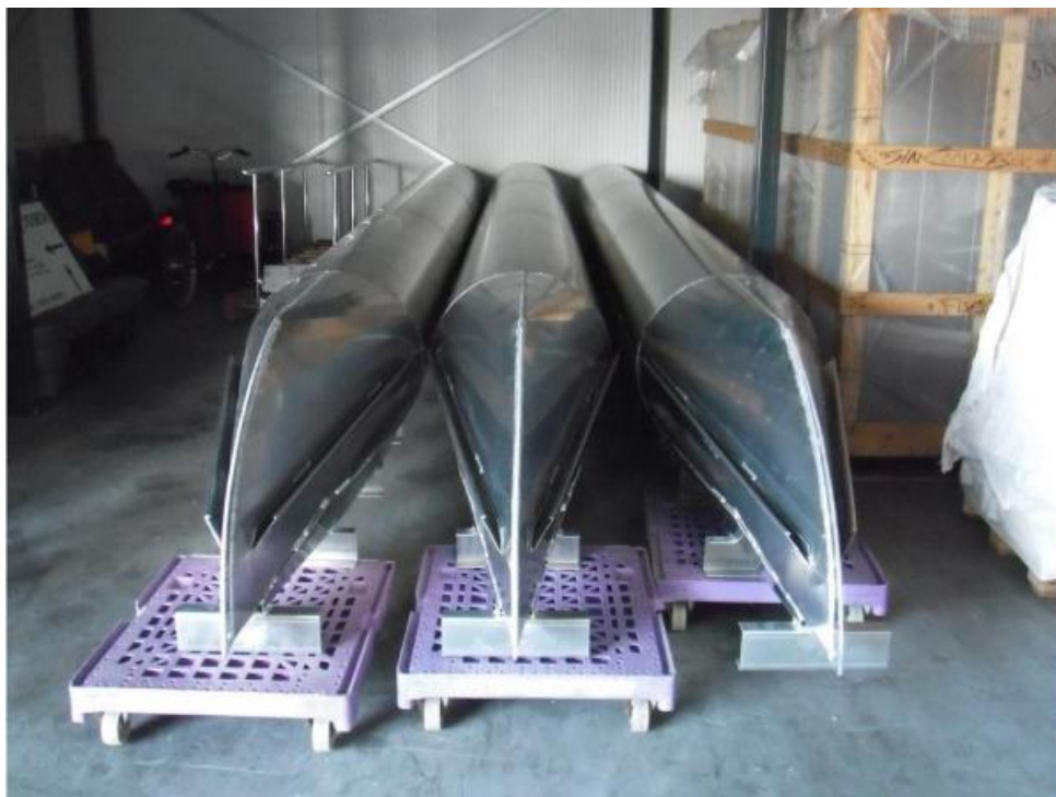
Drijvers van de Fluisterboot Ø640mm
